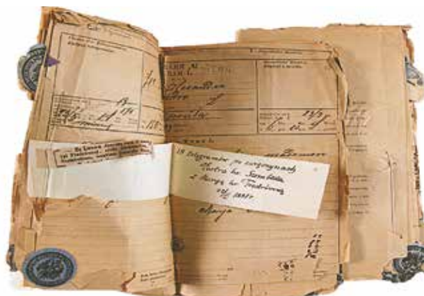
Fot. 3. Rękopis na papierze maszynowym o niskiej trwałości, widoczne liczne uszkodzenia i deformacje (z blogu PKZB)
